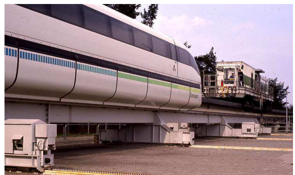
図2 ドイツの開発した電磁吸引浮上、常電導リニア同期モータ推進の高速磁気浮上鉄道 Transrapid 07 (エムスランド試験線にて)
