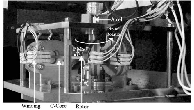
Fig. 8. Prototype motor.
