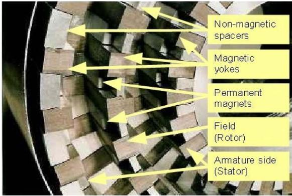
Fig. 1. Transverse flux machine.
