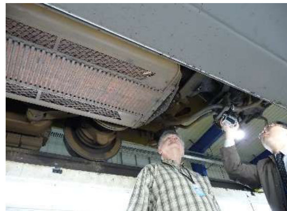
図1 車上一次形リニア誘導モータ Fig. 1 Short stator linear induction motor
