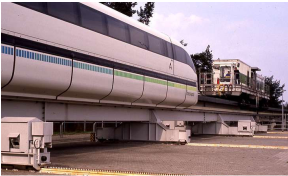
図5 ドイツの開発した電磁吸引浮上，城電導リニア同期モータ推進の高速磁気浮上鉄道 Transrapid 07（エムスランド試験線にて）
