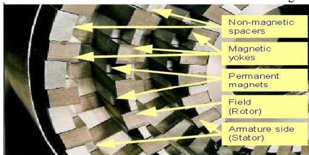
Fig. 1. Transverse Flux Machine<sup>[7]</sup>
