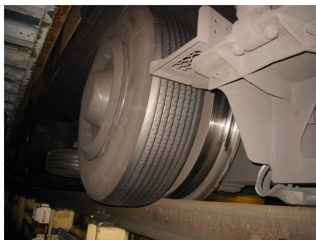
ゴムタイヤの内側に設けられている鉄車輪-鉄レール系 (b) Iron wheel-rail system for track circuit
