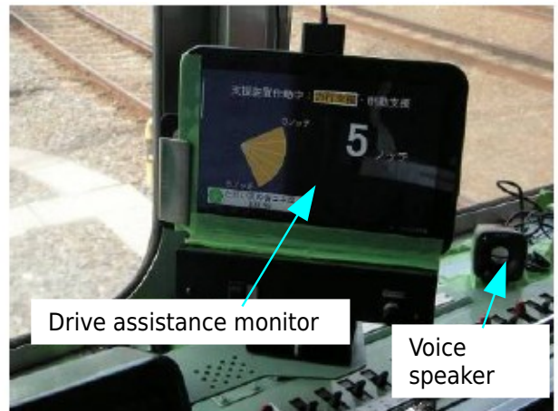
図8 車上運転支援装置の運転士に対するインターフェース
